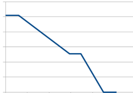
SP### très spécial : valeurs minimale, maximale, centre désaxé, sortie retournée zone neutre élargie \pm 5\%
